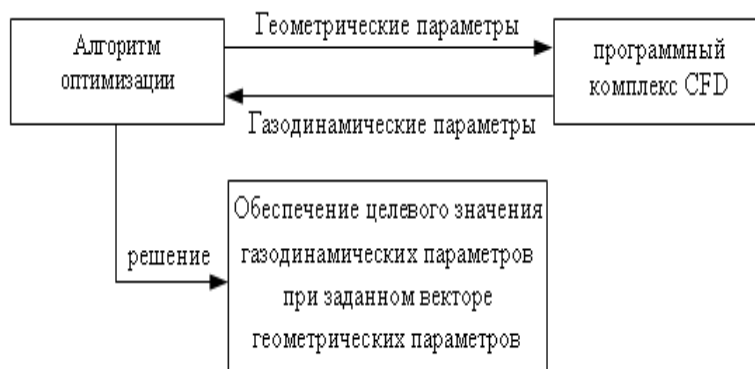
Рис. 1 – Интеграция CFD программ и алгоритмов оптимизации
